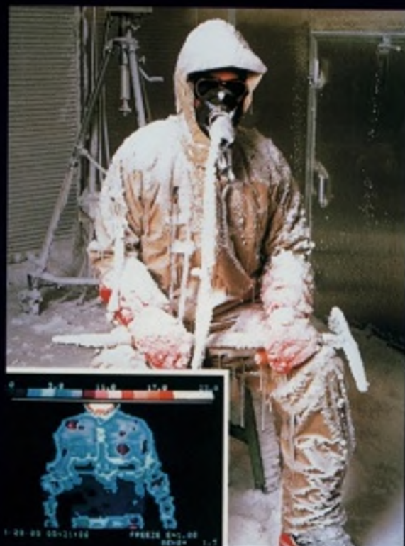
Blick in das Technorama, die künstliche Klimakammer von Toray. Hier wird das Gewebe barten Tests unterzogen.
