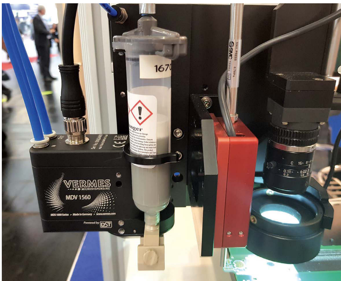
Das Vermes-Mikrodosiersystem MDS 1560 mit Dynamic Shockwave Technology (Bild: Anja Zierler/Markt&Technik)
