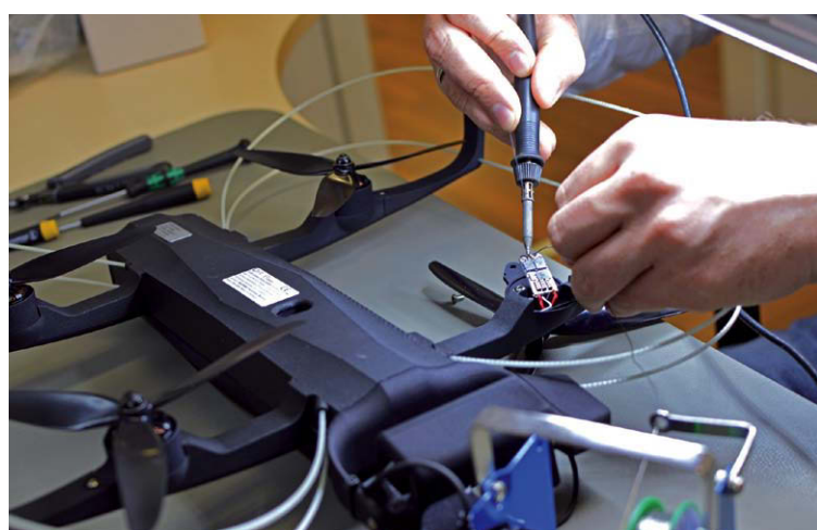
In Handarbeit lötet die Entwickler auf engem Raum immer wieder neue LEDs auf die Baugruppen. (Bild: U-Rob)
