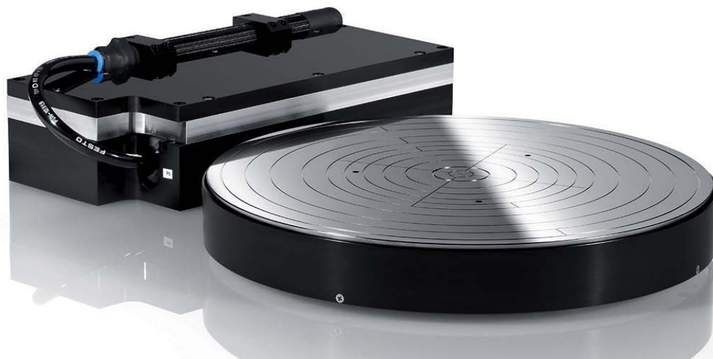
Die Thermo-Chucks vom Typ HTU Aircool AC3 stehen jetzt für die Aufnahme von Wafern mit Durchmessern von 200 mm und 300 mm zur Verfügung. Ihre Temperaturabweichung über die gesamte Fläche liegt unter \pm 0,1\text{ }^{\circ}\text{C} . Die Temperaturstabilität ist besser als \pm 0,03\text{ }^{\circ}\text{C} . (Bild: ERS)
