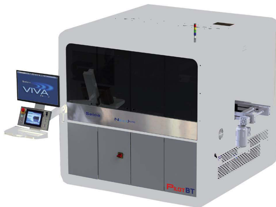
In der Maximalkonfiguration mit vier Flying-Probe-Köpfen führt der Pilot BT parallel Kelvin-Tests von 16 Zellen auf einmal durch und erreicht dabei Produktionsraten von fast 2400 Batteriezellen pro Minute. (Bild: Seica)
