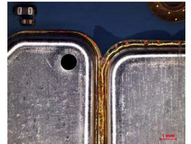
Links: Originalblech ohne Rework; rechts: durch Rework getauschtes Blech
