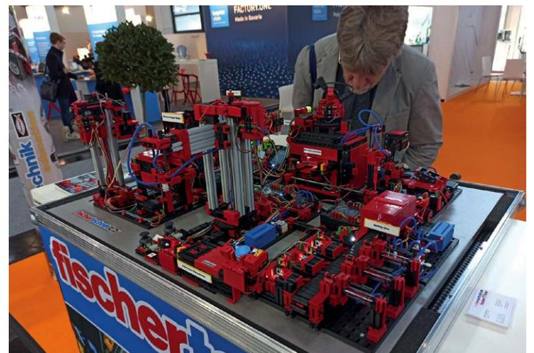
Der Konstruktionsbaukasten-Hersteller fischertechnik zeigt an seinem Stand seine „Lernfabrik 4.0“, die von der Größe her auf einen Schreibtisch passt. Die modulare Fabrikanlage demonstriert verschiedene Arbeitsgänge einer echten Ferti-
